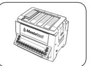
Colorar el cartucho en el labbox con las flechas hacia la parte posterior del mismo y coloca la tapa del labbox.
